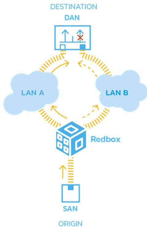
Figure a. Parallel Redundant Protocol
